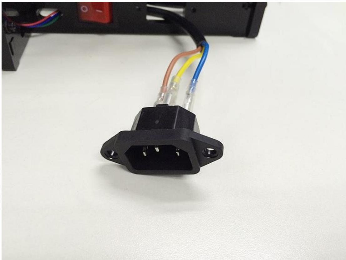
Korak 2. Postavite utičnicu na dno desne strane panela sa 2 M3 x 16 šesterokutnim brojilom, vijčanim vijkom, M3 podložnom pločicom i M3 šesterokutnom maticom.
