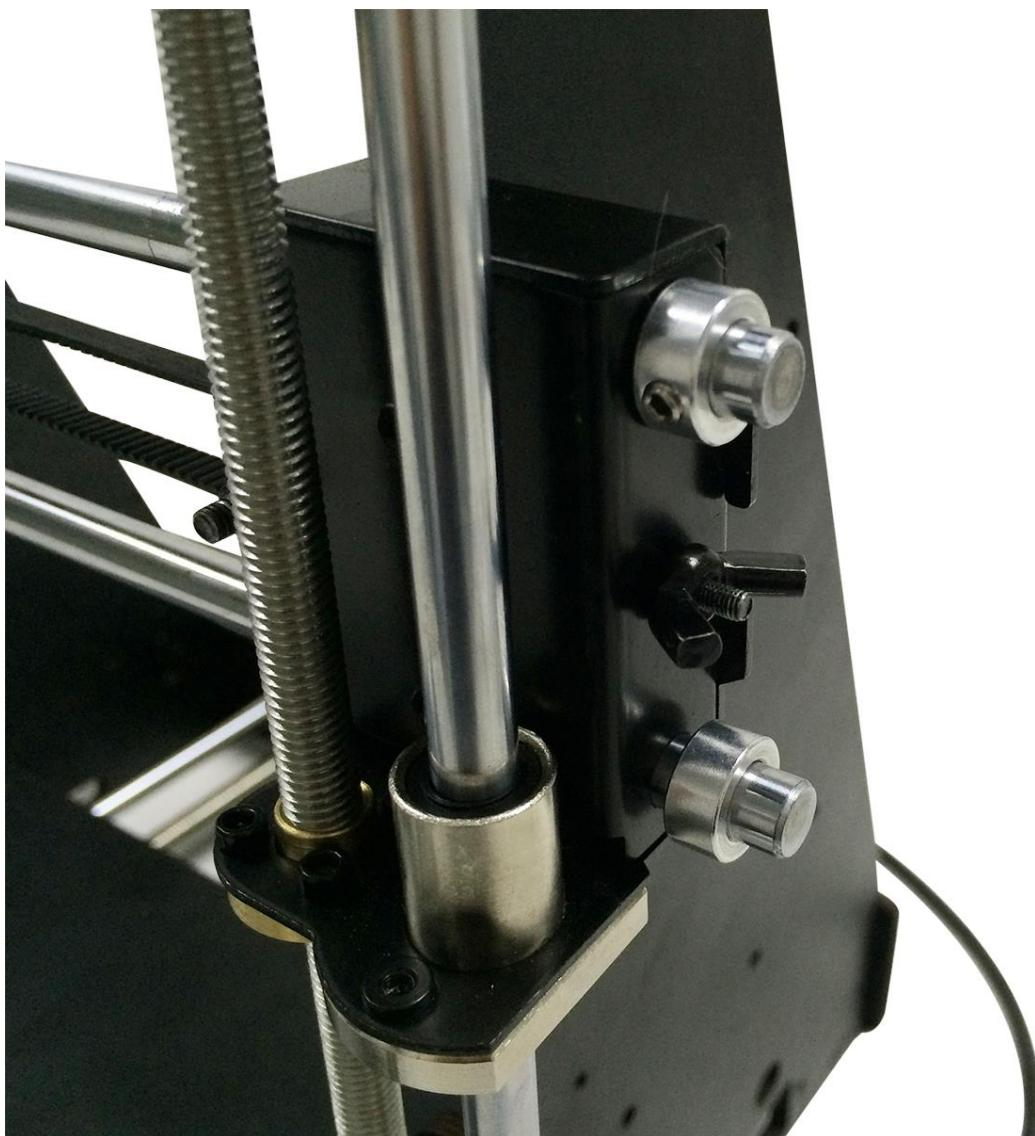
Savjet: Vrlo je bitno da je vertikalnost glatke šipke i Z osi ispravna, također i horizontalnost X osi, u suprotnom doći će do ometanja pokretljivosti Z osi.
