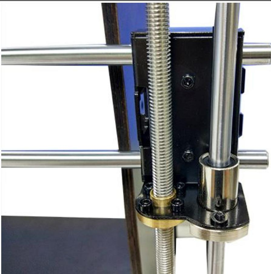
Korak 6. Nataknite vertikalnu glatku šipku na spojku desnog motora Z osi. Zatim nanižite 320mm glatku šipku na linearni ležaj.
