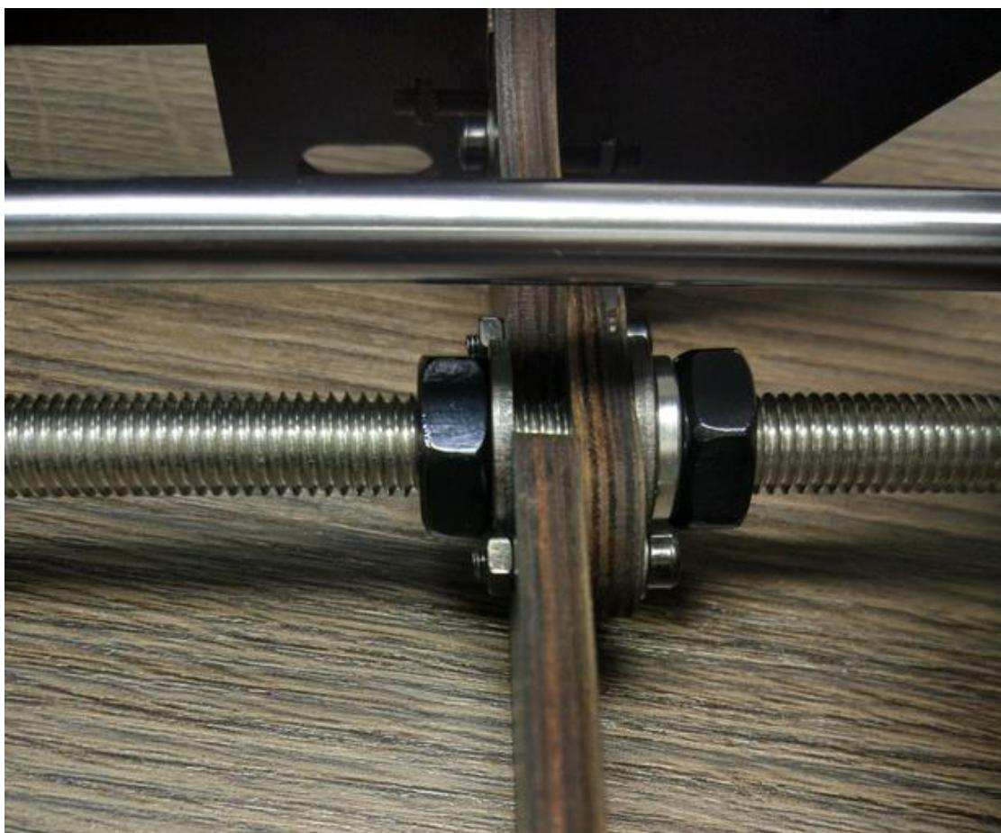
Korak 2. Zavijte bočnu ploču Y osi za bočni panel sa M3 x 16mm vijkom, M3 podložnom pločicom i M3 kvadratnom maticom.
