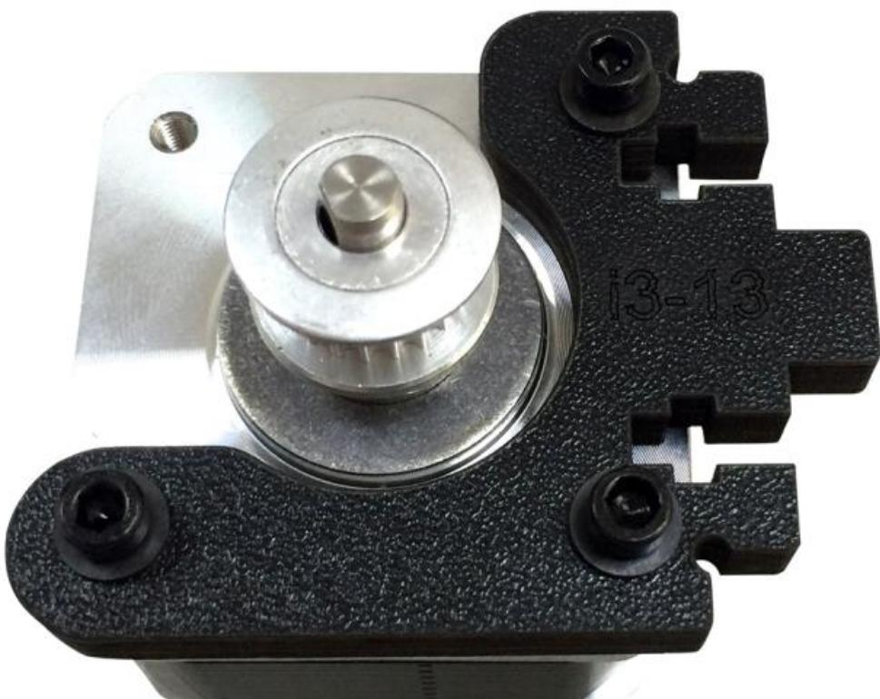
Korak 3. Pritisnite držalo Y motora u kvadratni otvor na stražnjoj ploči. Zatim ga učvrstite sa 2 M3x16mm vijka, M3 podložnom pločicom i M3 kvadratnom maticom.
