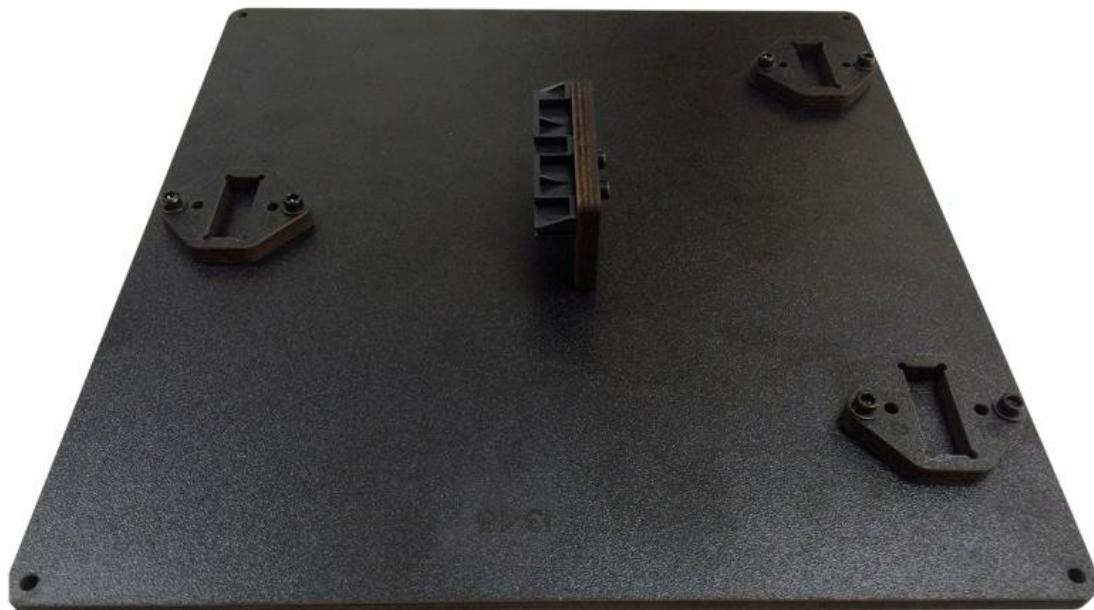
Korak 4. Stavite potpornu platformu na držač Y osi, zatim međusobno učvrstite zip vezicama za 3 linearna ležaja Y osi. (Obratite pažnju na smjer: Držač remena je u ravnini sa remenicom motora Y osi.)
