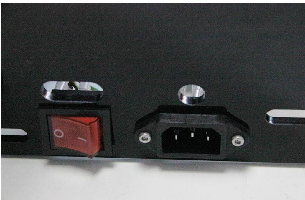
Korak 3. Izlaznu snagu smjestite na dno printera, zatim provucite kroz otvor na panelu sa desne strane.
