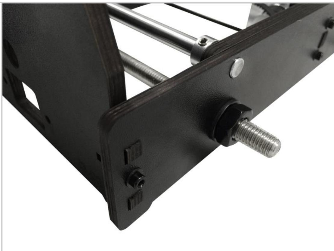
Korak 3. Zavijte glavni okvir za spojnu ploču Y osi sa 4 M3 x 16mm vijcima, M3 podložnim pločicama i M3 maticama.
